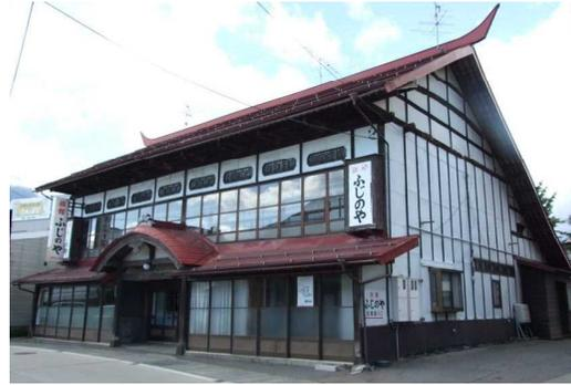
その特徴としては屋根が切妻造鉄板葺（きりづまづくりてっぱんぶき）で、背面側の屋根が1階までの葺き降ろし。正面に庇（ひさし）をかけ、切妻屋根を中央に付けてた玄関が、明治時代末の旅館のたたずまいを伝えているのだそうです。
