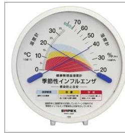
**一目でわかる指針交点表示！** 温度計針と湿度計針の交差しているゾーンが室内のインフルエンザ感染防止目安を示します。加湿器や暖房器具の設定を調節することによりインフルエンザの感染リスクを減らせます。
