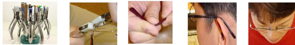
20本以上の工具を使用します。 複数の工具でメガネの角度調整 耳へ掛ける部分を丁寧に曲げます 耳やお顔の形にピッタリ合わせます 鼻パッドもベストフィット！
